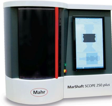
MarShaft SCOPE 250 plus는 250 mm의 측정 범위와 함께 고정밀 원형 측정 축 (C)과 수직 측정 축(Z)을 지원합니다. 이 솔루션의 핵심은 1088 x 2048 mm의 이미지 필드를 갖춘 최첨단 고해상도 CMOS 매트릭스 카메라 (라이브 이미지)에 있습니다. 초당 120개 이상 이미지에 달하는 매우 높은 이미지 수집 속도 덕분에 측정 시간을 최소한으로 유지할 수 있습니다. 줌 기능을 이용하면 기존의 측정 방법으로는 테스트조차 불가능했던 가장 작은 디테일을 측정할 수 있습니다.
