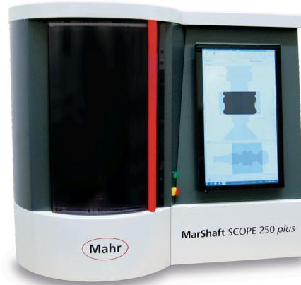
MarShaft SCOPE 250 plus は、高精度の真円度測定軸 (C) と垂直測定軸 (Z) を装備しており、測定範囲は250mmです。その心臓部は、1088 x 2048 mmの画像フィールドを持つ最先端の高解像度 CMOSマトリックスカメラ (ライブ画像) です。1秒間に120画像以上の極めて高速な画像取得により、測定時間を最小限に抑えることができます。ズーム機能により、従来の測定方法では不可能ではないにしても困難だった細部の測定が可能になります。
