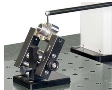
Los topes guía enchufables y la amplia gama de dispositivos de sujeción estandarizados, así como los alojamientos de piezas de trabajo, permiten un posicionamiento flexible de la pieza de trabajo.
