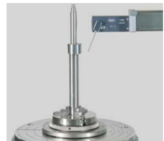
T7W: Vollautomatischer Wechsel zwischen Innen- und Außenmessungen
