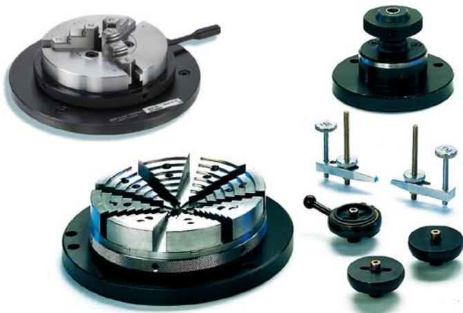
**Dreibackenfutter mit 3 Backen Ø 100 mm** mit Befestigungsflansch Ø 160 mm, umkehrbare Backen für Außen- und Innenspannung. Spannbereich außen 1-100 mm, innen 36-90 mm. Gesamthöhe mit Flansch 47 mm. Verstellung über Drehring.
