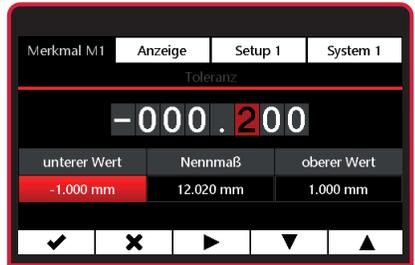
☞ Toleranzwerte für unterer Wert und oberer Wert müssen relativ zum Nennmaß eingegeben werden.
