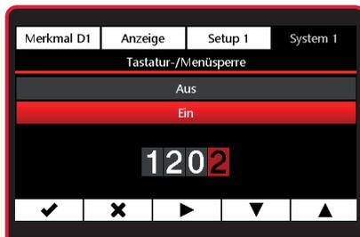
Bei eingeschalteter Menüsperre, wird der Benutzer beim Menüaufruf zur PIN-Eingabe aufgefordert. Wurde die Pin richtig eingegeben, wird das Menü aufgerufen.
