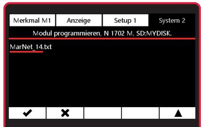
Im Display wird angezeigt welches Modul eingesetzt ist.
