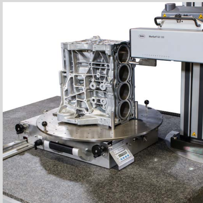
Rauheitsmessung am Motorblock
