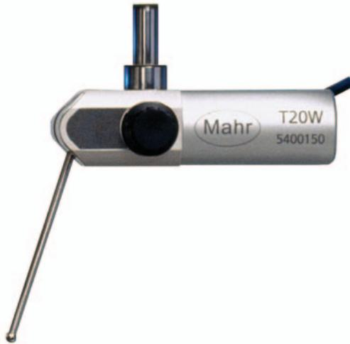
Der induktiv arbeitende Messtaster **T20W** ist universell einsetzbar. Durch den im Bereich von 180°-winkelbeweglichen Tastarm und die verschiedenen Einspannmöglichkeiten des Tasters kann auch an schwer zugänglichen Stellen gemessen werden. Um den Taster den jeweiligen Messaufgaben oder Werkstücken anzupassen, können Sie leicht auswechselbare Tastarme mit verschiedenen Messeinsätzen kombinieren.
