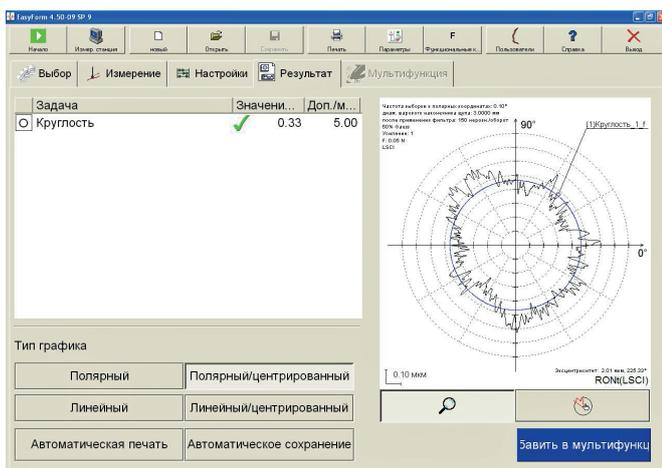
Выравнивание детали происходит при поддержке компьютера. Позиция измерения автоматически записывается программой. Детальная трехмерная графика увеличивает информативность представления результатов измерения. Более того, вы можете по желанию поворачивать графику для оптимального представления результата.
