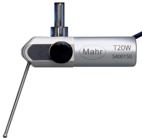
Индуктивная головка **T20W** является универсальным устройством. Щуповая консоль может поворачиваться на 180°, что в сочетании с многочисленными вариантами крепления щуповой консоли дает возможность измерения в труднодоступных местах. Вы можете использовать комбинации быстросменных щуповых консолей с различными наконечниками для адаптации головки к конкретной задаче измерения.
