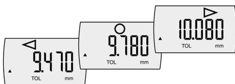
**Toleranzdarstellung ohne Messwertanzeige.** Toleranzüber- bzw. unterschreitung wird ausschließlich durch Symbole angezeigt
