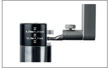
图 13 用凹槽校准时定位校准块
