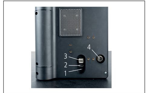
图 10 USB 插口 1 Mini USB 2 1 x USB 3.1 (黑色) 3 2 x USB 3.1 (白色) 4 8 针圆形插头，用于为控制面板供电
