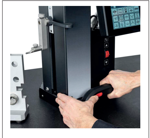
图 8 使用激活的气浮移动测高仪
