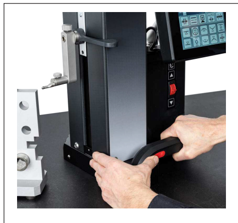
Rys. 7 Przeszczanie wysokościomierza za pomocą aktywowanego łożyska pneumatycznego
