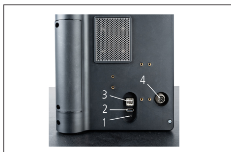
Rys. 9 Gniazda przyłączeniowe USB 1 Mini USB 2 1 x USB 3.1 (czarne) 3 2 x USB 3.1 (białe) 4 8-polowa okrągła wtyczka do zasilania panelu obsługi
