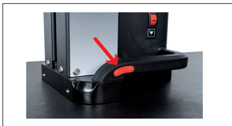
Rys. 5 Przycisk do aktywacji łożyska pneumatycznego (Ilustracja przedstawia model Digimar 817 CLT.)
