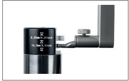
그림 12 흠을 포함해 교정할 때 세팅 게이지의 위치 이동
