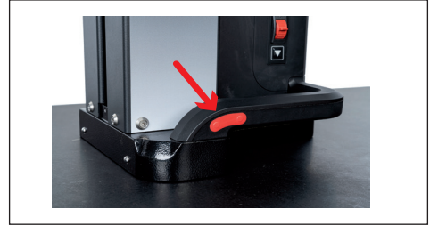
그림 5 에어 베어링을 활성화하기 위한 버튼 (그림은 Digimar 817 CLT만을 보여줍니다.)
