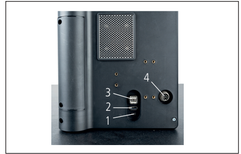
그림 9 USB 소켓 1 미니 USB 2 1 x USB 3.1(검정색) 3 2 x USB 3.1(흰색) 4 제어 패널에 전원을 공급하기 위한 8핀 원형 플러그
