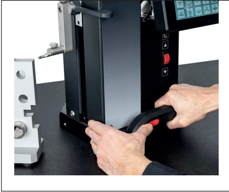
그림 7 활성화된 에어베어링을 사용해 하이트 게이지를 이동 (그림은 Digimar 817 CLT만을 보여줍니다.)
