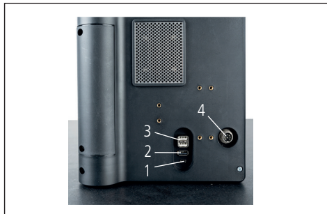
9. ábra USB csatlakozóaljzatok 1 Mini USB 2 1 db USB 3.1 (fekete) 3 2 db USB 3.1 (fehér) 4 8 pólusú kerek csatlakozódugó a kezelőpanel feszültségellátásához
