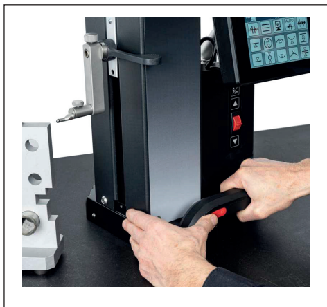
7. ábra A magasságmérő készülék mozgatása aktívált légcsapágy segítségével (Az ábrán a Digimar 817 CLT látható.)
