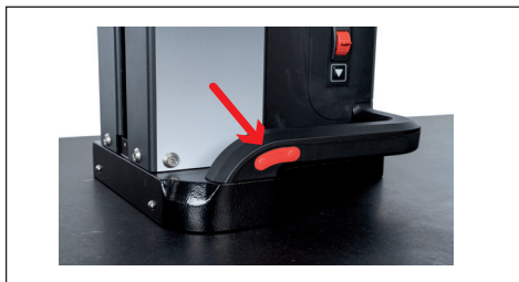
5. ábra Nyomógomb a légcsapágy aktiválásához (Az ábrán a Digimar 817 CLT látható.)
