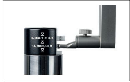
12. ábra A beállítóblokk pozicionálása a horonnyal való beméréskor
