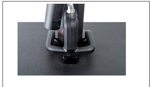
Abb. 6 Griffe zum Bewegen des Messgerätes (Abbildung zeigt das Digimar 817 CLT.)
