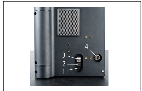
Abb. 9 USB-Anschlussbuchsen 1 Mini-USB 2 1 x USB 3.1 (schwarz) 3 2 x USB 3.1 (weiß) 4 8-poliger Rundstecker für die Spannungsversorgung des Bedienpanels
