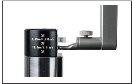
Abb. 12 Positionierung des Einstellblocks beim Einmessen mit Nut
