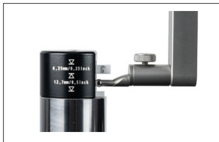
Obr. 12 Nastavení polohy nastavovacího bloku při kalibraci na drážce
