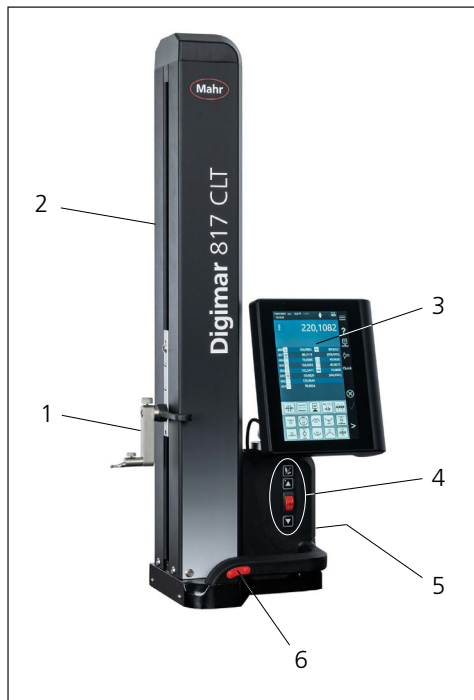
Obr. 1 Prvky výškoměru (Na obrázku je Digimar 817 CLT.)
