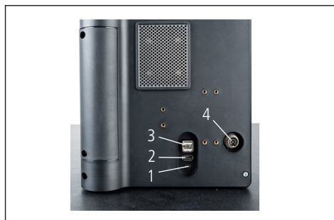
Obr. 9 Připojovací konektory USB 1 Mini-USB 2 1× USB 3.1 (černá) 3 2× USB 3.1 (bílá) 4 8 pólový kruhový konektor pro napájení ovládacího panelu
