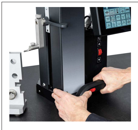
Obr. 7 Pohyb výškoměru pomocí aktivovaného vzduchového ložiska (Na obrázku je Digimar 817 CLT)
